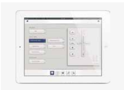
KNX / gBUS Steuerung per iPad
